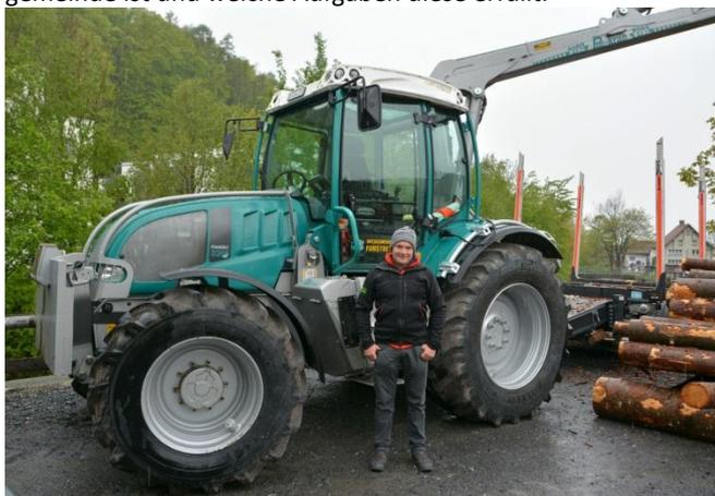
Vielseitig verwendbar: Der neue PM-Trac mit Kran, gesteuert von Thomas Ackermann, kann zum Mulchen, für Strassenbau- und Rückarbeiten sowie mit Anhänger für Holz- und andere Transporte eingesetzt werden. Bild: zvg
